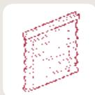
**le store plissé**, en textile, est réalisé dans une fine toile plissée en forme d'accordéon.
