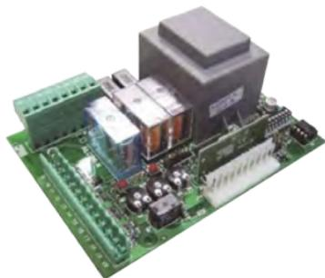
Armoire de commande à interrupteurs de programmation (dip switch) pour un ou deux opérateurs 230 V/300 W pour la motorisation de portails battants
