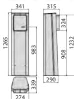
La borne Espas20-I, en combinaison avec une barrière électromécanique et une paire de spires, est un dispositif de contrôle des entrées dans une aire de stationnement. Le système est stand alone (autonome) et ne nécessite aucun câblage entre les différents éléments du parking
