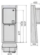
La caisse automatique Espas30-P a été conçue pour équiper les installations de parking professionnelles câblées d'un dispositif qui permet le maximum de fonctionnalités et de performances pour le paiement automatique. Elle doit être reliée au serveur du système par réseau Ethernet
