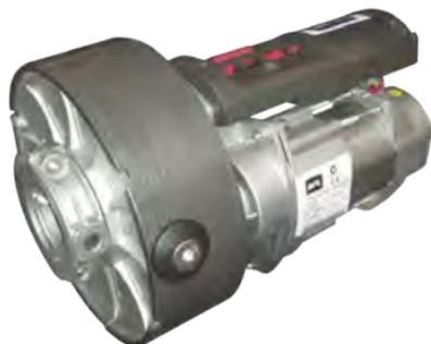
Opérateurs 230 V pour rideaux métalliques fournissant un couple maximum jusqu'à 445 Nm. Adaptés à équipés les rideaux avec poulie de 200, 220, 240 et 280 mm de diamètre et arbre de 42, 48, 60, 76 et 101 mm de diamètre. Existent en versions avec ou sans électrofrein.
