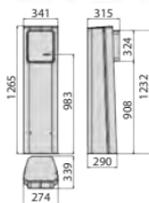
La borne d'entrée Espas 30-I, en combinaison avec une barrière électromécanique et une paire de spires, est un dispositif de contrôle des entrées d'une aire de stationnement. Elle est conçue pour systèmes câblés, et doit donc être connectée aux autres éléments du système via réseau série RS485
