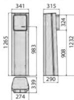
La borne de sortie Espas 30-U, en combinaison avec une barrière électromécanique et une paire de spires, est un dispositif de contrôle des sorties d'une aire de stationnement. Elle est conçue pour systèmes câblés, et doit donc être connectée aux autres éléments du système via réseau série RS485
