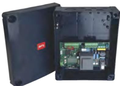
Armoire de commande à afficheur pour un ou deux opérateurs 230 V/300 W pour la motorisation de portails battants et de portes industrielles pliantes
