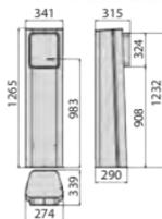
La borne Espas H20-U, en combinaison avec une barrière électromécanique et une paire de spires, est un dispositif de contrôle des sorties d'une aire de stationnements. Le système est stand alone (autonome) et ne nécessite aucun câblage entre les différents éléments du parking
