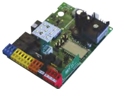
Armoire de commande pour 1 ou 2 opérateurs pour la motorisation de portes de garage basculantes.
