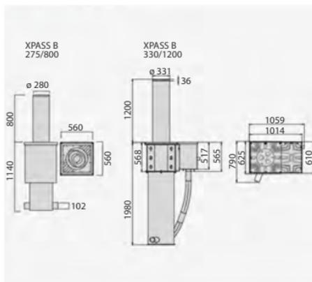
Dispositifs de dissuasion contre le terrorisme, testés et certifiés (crash-tested) par un organisme indépendant, selon les normes IWA14-1:2013 V/7200(N3C)/80/90 et PAS 68:2010 7500/50/N2 crash simulated (ex K12 et K4, dispositif de dissuasion autonome).
